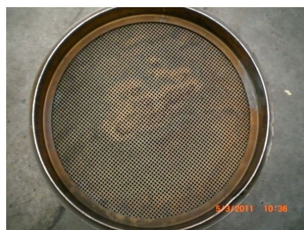
So sieht ein von uns gereinigter / regenerierter und wieder einsatzbereiter Filter aus.
